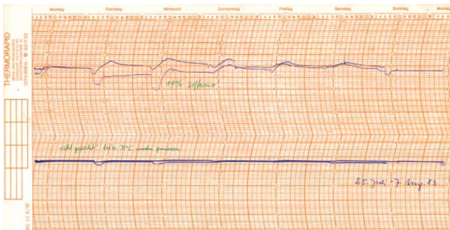
Abb. A.16: Thermohygrographenblatt vom 25. Juli bis 7. August 1983. Das jahrelang nicht mehr geeichte Gerät zeigte um 2,5 °C zu niedrige Temperaturen an.
