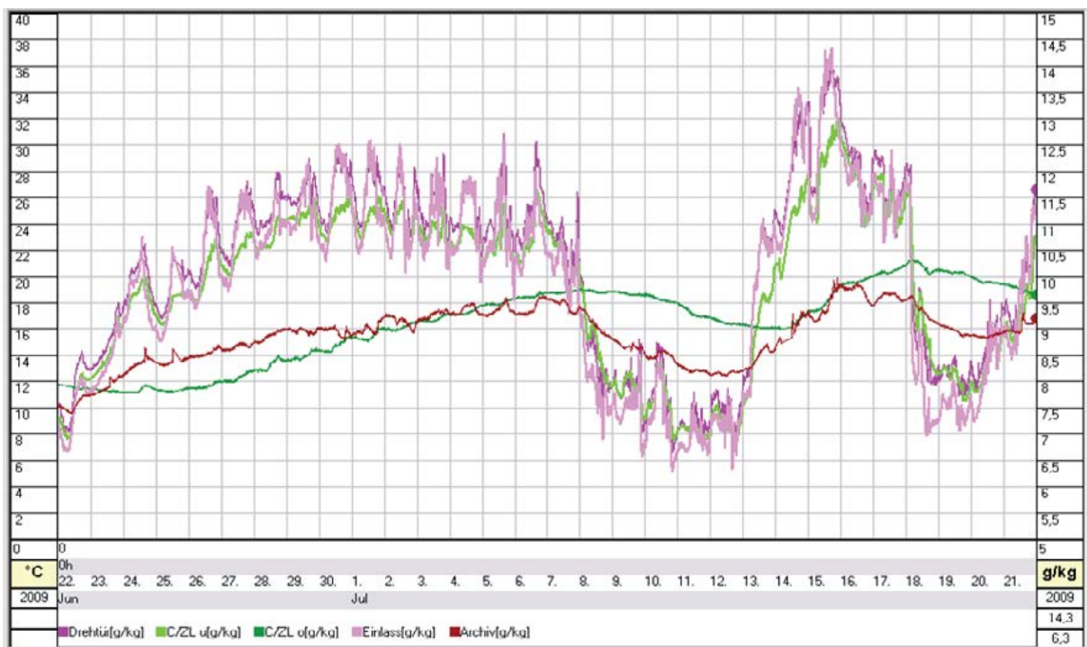
Abb. B.30: Bei hoher Außenluftfeuchte (>13 g/m 3 ) wird der Luft auf ihrem Weg vom Einlass (rosa), über die Drehtür (pink) bis zum Fußpunkt der Steigschächte (hellgrün) ca. 1 g/m 3 Wasserdampf entzogen. Im Gebäudekern (Archiv - rostbraun) und in den Steigschächten (dunkelgrün) findet ein weiterer Ausgleich der absoluten Feuchte um einen konservatorisch und physiologisch günstigen Mittelwert (8-10 g/m 3 ) statt (Juni/Juli 2009).
