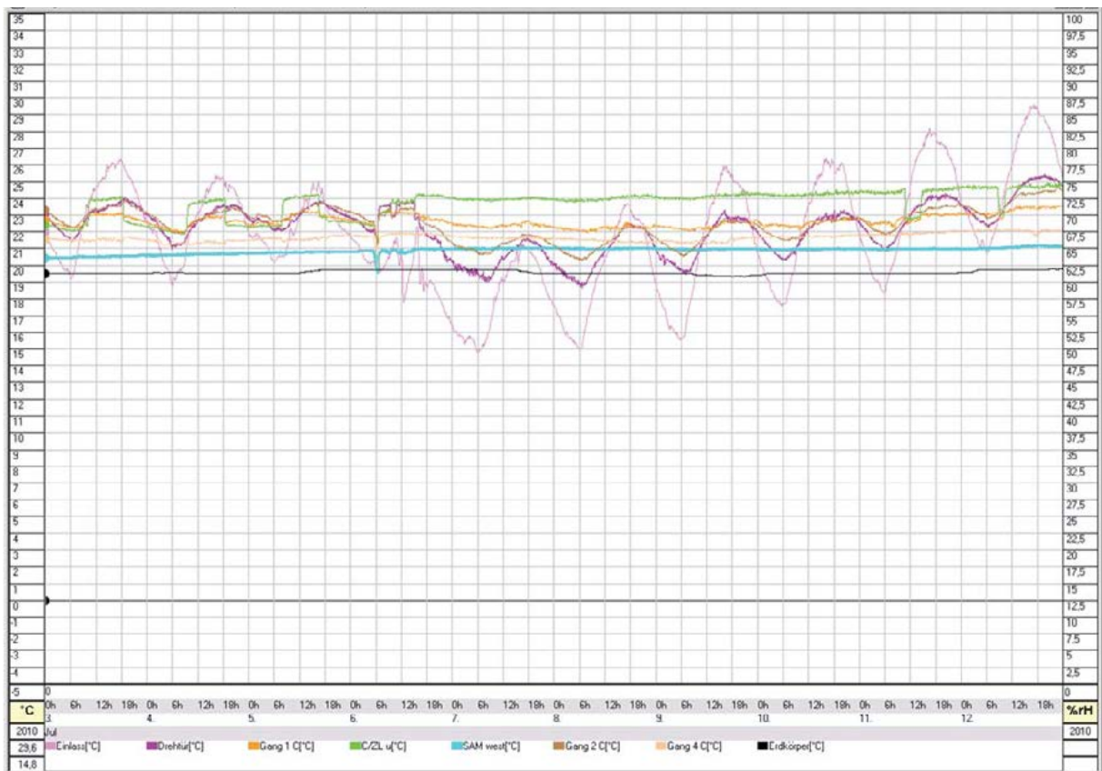
Abb. B.27: Im Sommer wird die Außenluft von den kühlen Mauerflächen abgekühlt (Kollektorgang West - türkis; Juli 2009)
