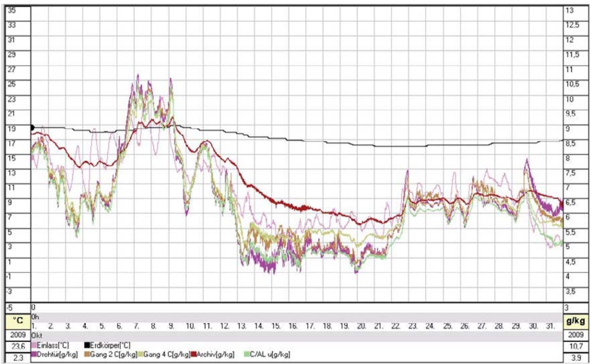
Abb. B.26: Die Schwankungen der Luftfeuchtigkeit (26a - oben: relative Feuchte; 26b - unten: absolute Feuchte) der Außenluft (rosa und pink) werden bis ins Zentrum des Luftbrunnens (Archiv – rostbraun) vom Ziegelmauerwerk gepuffert. Am 29.10. wurde die Drehtür geschlossen (Oktober 2009)
