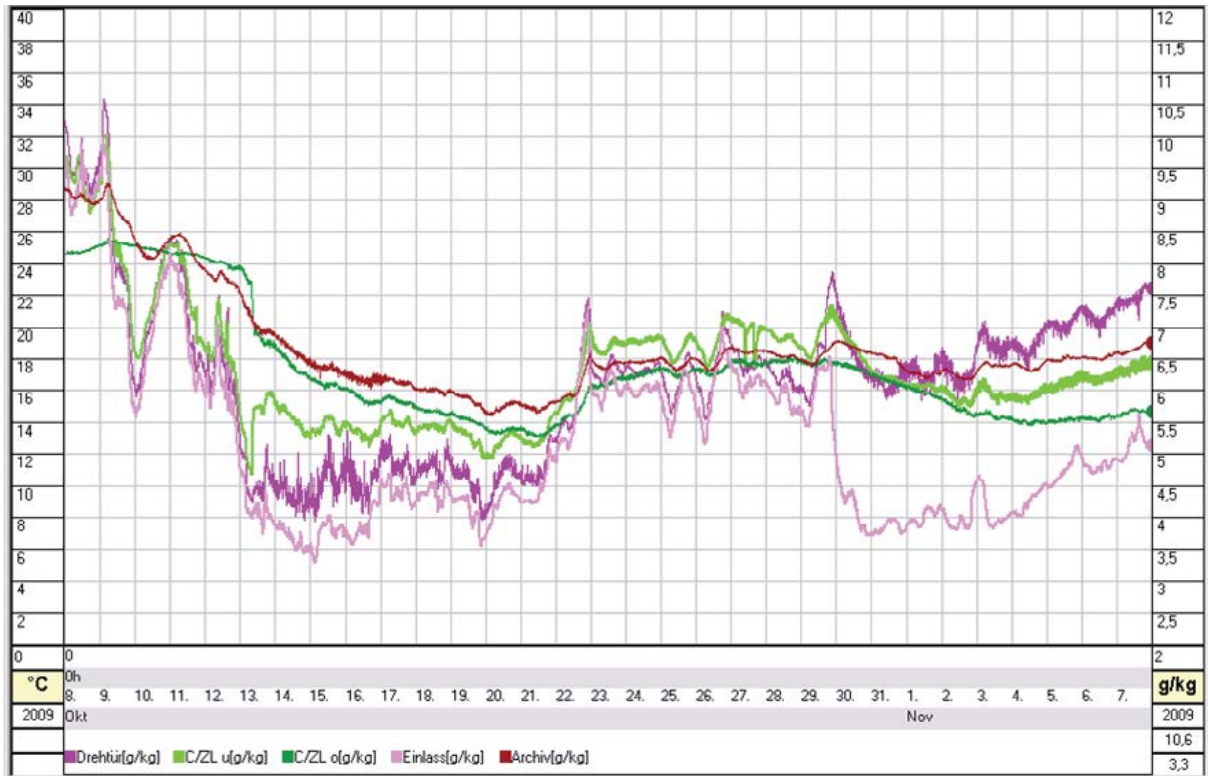
Abb. B.33: Am Beginn der Heizperiode wird das Befeuchtungspotential und die Pufferwirkung des Luftbrunnens sichtbar (8.10.-8.11.2009)
