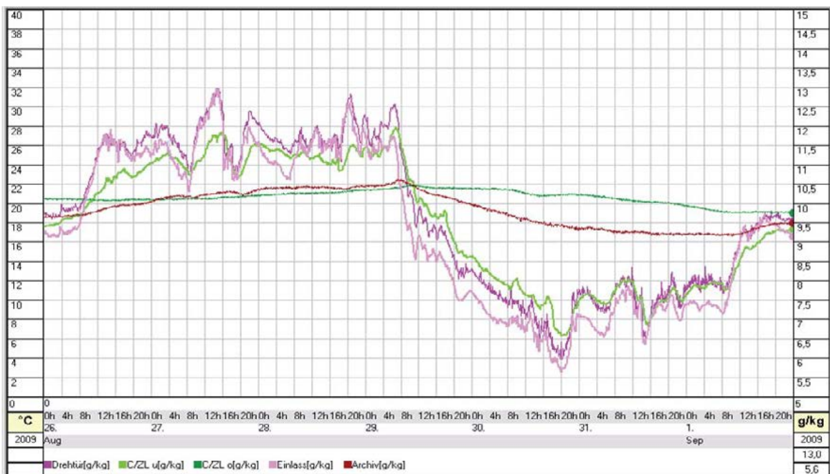
Abb. B.32: Bei Einströmen trockener Außenluft wird Wasser den Mauerflächen entzogen und bewirkt eine Vorbefeuchtung der Zuluft (29.8.-2.9.2009)
